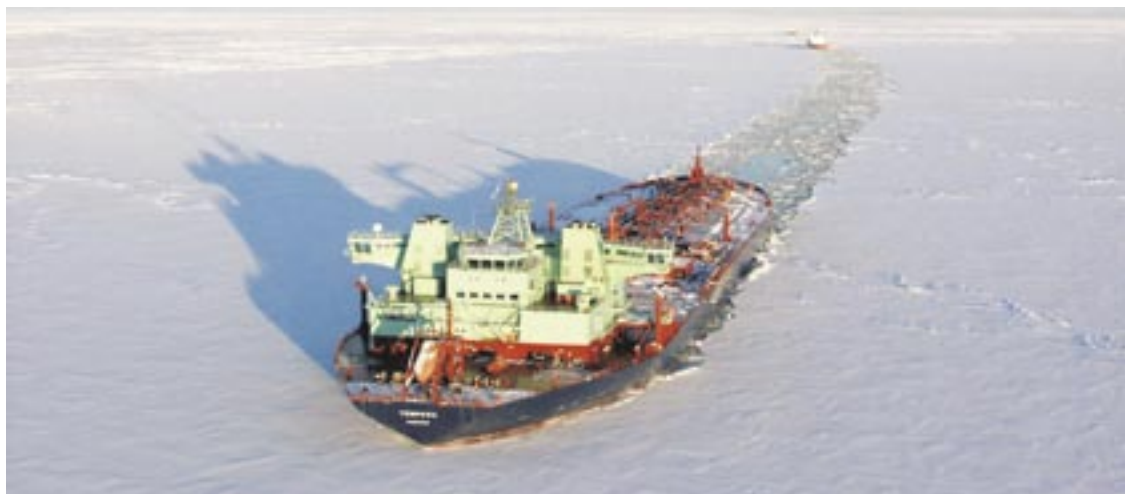
Olíuskipið Tempera, 106.000 tonn, er hannað fyrir siglingar í ís jafnt sem á opnum sjó. Það var eina olíuflutningaskipið sem gat siglt án aðstoðar ísbrjóta á Eystrasalti veturinn 2003 þegar ísinn var 80 cm þykkur.
