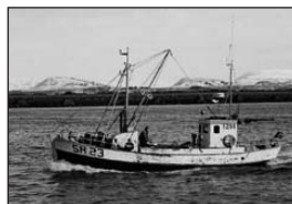
Kristján S SH 23 / 1214. Skipaskr.nr. 1214. Smíðaður: Seyðisfirði, 1972/-. Eik. Stærð: 12 brl., 15 bt. Mesta lengd: 13,50 m Skráð lengd: 12,00 m Breidd: 3,37 m Dýpt: 1,29 m Vél: Ford Mermaid 200 kW (271 hó) Fjöldi skipverja: 2
