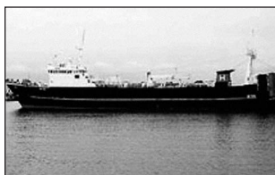
Venus HF-519. Skipaskr.nr. 1308. Smíðaður: Stál, San Juan, Spáni, 1973. Stærð: 1156 brl. 1779 bt. Mesta lengd: 77,53 m. Skráð lengd: 69,22 m. Breidd: 11,60 m. Dýpt: 7,50 m. Vél: MaK 2355 kW. Fjöldi skipverja: 27
