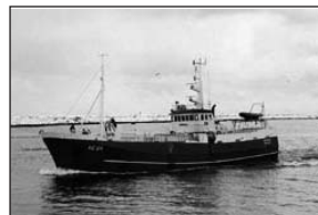
Sædis HF 60. Skipaskr.nr. 89. Smíðaður: Flekkefjord, Noregi, 1963/10, Stál. Staerð: 179 brl. 275 bt. Mesta lengd: 36,50 m. Skráð lengd: 32,83 m. Breidd: 6,72 m. Dýpt: 5,72 m. Vél: Caterpillar 671 kW. Fjöldi skipverja: 12
