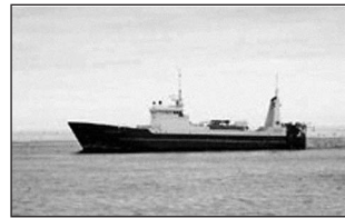
Sigurbjörg ÓF-1. Skipaskr.nr. 1530. Smíðaður: Stál, Akureyri, 1979. Stærð: 516 brl. 893 bt. Mesta lengd: 54,98 m. Skráð lengd: 48,91 m. Breidd: 10,26 m. Dýpt: 6,90 m. Vél: Wärtsilä 1985 kW. Fjöldi skipverja: 26
