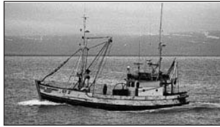
Röst SH 134 Skipaskr.nr. 1317. Smíðaður: Skagaströnd, 1973/-, Eik. Stærð: 30 brl. 31 bt. Mesta lengd: 17,40 m. Skráð lengd: 15,18 m. Breidd: 4,48 m. Dýpt: 2,05 m. Vél: Cummins 224 kW
