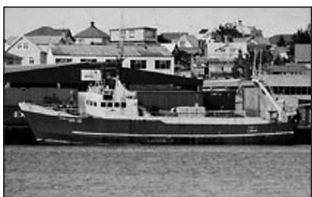
Sturla GK-12. Skipaskr.nr. 1612. Smíðaður: Stál, Wallsend, Bretlandi 1974. Stærð: 297 brl. 276 bt. Mesta lengd: 35,87 m. Skráð lengd: 31,92 m. Breidd: 8,32 m. Dýpt: 4,90 m. Vél: Bergen Diesel 729 kW (990 hö). Fjöldi skipverja: 10
