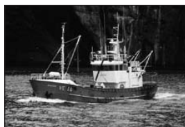
Bjarmi VE 66 Skipaskr.nr. 1103. Smíðaður á Seyðisfirði 1970 úr stáli. Stærð: 58 brl, 53 BT. Mesta lengd 22,30m. Skráð lengd: 19,33 m. Breidd: 4,80m, Dýpt: 2,45m. Vél: Caterpillar 300 kW, árgætt 1994. Fjöldi skipverja: 4
