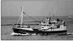
Sandafell ÍS 82. Skipaskr.nr. 1812. Smíðaður: Gdansk, Póllandi, 1988/8. Stærð: 89,5 brl. 111 bt. Mesta lengd: 25,93 m. Skráð lengd: 23,47 m. Breidd: 6,00 m. Dýpt: 3,00 m. Vél: Caterpillar 456 kW, 1988.
