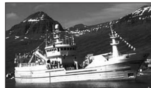
Hoffell SU 80. Skipaskr.nr. 2345. Smíðaður: Hoogezand í Hollandi 1981. Stærð: 674 brl. 1293 bt. Mesta lengd: 61,14 m. Skráð lengd: 59,6 m. Breidd: 9,5 m. Dýpt: 7,0 m. Vél: MaK, 2940 kW, 1993. Fjöldi skipverja:
