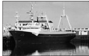
Bravó SH 543. Skipaskr.nr. 1268. Smiðaður: Gdynia, Póllandi, 1972/11, Stál. Stærð: 857 brl. 1126 bt. Mesta lengd: 67,92 m. Skráð lengd: 61,35 m. Breidd: 11,30 m. Dýpt: 7,30 m. Vél: Mirlees Blackst 1596 kW. Fjöldi skipverja: 7
