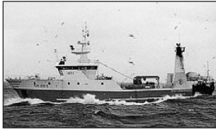
Hrafn Sveinbjarnarson GK-255. Skipaskr.nr. 1972. Smíðaður: Stál, Flekkefjord, Noregi, 1988/10. Stærð: 390 brl. 1028 bt. Mesta lengd: 47,90 m. Skráð lengd: 39,30 m. Breidd: 11,00 m. Dýpt: 7,45 m. Vél: Deutz 1850 kW. Fjöldi skip- verja: 24
