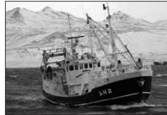
Egill Halldórsson SH-2 Skipaskr.nr. 1458. Smíðaður: Stál, Seyðisfirði, 1976. Stærð: 101 brl. 114 bt. Mesta lengd: 26,92 m. Skráð lengd: 23,90 m. Breidd: 5,90 m. Dýpt: 3,10 m. Vél: Caterpillar 313 kW. Fjöldi skipverja: 6
