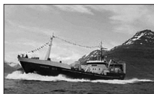
Hólmaborg SU 11. Skipaskr.nr. 1525. Smíðaður: Stál, Uddevalla, Svíþjóð, 1978/12. Staerð: brl. 1181 bt. 1682. Mesta lengd: 73,38 m. Skráð lengd: 67,00 m. Breidd: 12,00 m. Dýpt: 7,85 m. Vél: Wärtsilä 5520 kW. Fjöldi skipverja: 15
