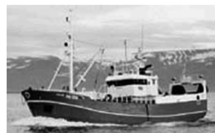
Sigbór ÞH-100. Skipaskr.nr. 185. Smíðaður: Stál, Marstrand, Svíþjóð. 1963 Stærð: 169 brl. 217 bt. Mesta lengd: 33,68. Skráð lengd: 29,66 m. Breidd: 6,73 m. Dýpt: 5,94 m. Vél: Caterpillar 626 kW. Fjöldi skipverja: 9
