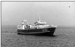
Farsæll SH 30. Skipaskr.nr. 1629. Smíðaður: Seyðisfirði, 1983/-. Stál. Stærð: 178 brl. 237 bt. Mesta lengd: 29,49 m. Skráð lengd: 26,16 m. Breidd: 7,00 m. Dýpt: 5,70 m. Vél: Caterpillar 671 kW Fjöldi skipverja: 8
