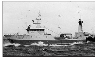
Hrafn Sveinbjarnarson GK-255. Skipaskr.nr. 1972. Smíðaður: Stál, Flekkefjord, Noregi, 1988/10. Stærð: 390 brl. 1028 br. Mesta lengd: 47,90 m. Skráð lengd: 39,30 m. Breidd: 11,00 m. Dýpt: 7,45 m. Vél: Deutz 1850 kW. Fjöldi skip- verja: 24
