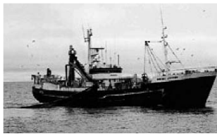
Júpíter ÞH-61. Skipaskr.nr.130. Smíðaður: Stál, Bremerhaven, Þýskalandi, 1957 Stærð: 747 brl. 1033 bt. Mesta lengd: 64,50 m. Skráð lengd: 56,83 m Breidd: 9,75 m. Dýpt: 7,68 m. Vél: Wärtsilä 1943 kW. Fjöldi skipverja: 15
