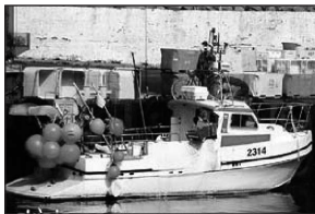
Þerna SH 350. Skipaskr.nr. 2314. Smíðaður: Hafnarfirði 1998, plast. Stærð: 6,80 brl. 5,75 bt. Mesta lengd: 9,05 m. Skráð lengd: 7,97 m. Breidd: 2,92 m. Dýpt: 1,18 m. Vél: Cummins 184 kW Fjöldi skipverja: 2
