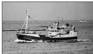
Sandafell ÍS 82 Skipaskr.nr. 1812. Smíðaður: Gdansk, Póllandi, 1988. Stærð: 90 brl. 111 bt. Mesta lengd: 25,93 m. Skráð lengd: 23,47 m. Breidd: 6,00 m. Dýpt: 3,00 m. Vél: Caterpillar 456 kW Fjöldi skipverja: 6
