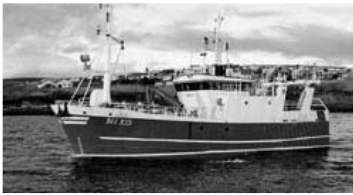
Aron ÞH 105. Skipaskr.nr. 2333. Smíðaður: Danmörk 1990, stál. Innfluttur 1998. Stærð: 127 brl. 211 bt. Mesta lengd: 25,45 m Skráð lengd: 23,28 m. Breidd: 7,0 m. Dýpt: 5,90 m. Vél: Caterpillar 666 kW Fjöldi skipverja: 5
