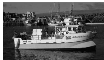
Guðbjörg ÍS 46. Skipaskr.nr. 2482. Smíðaður: Akranesi, 1988/-. Plast. Stærð: 9 brl. 6 bt. Mesta lengd: 9,12 m. Skráð lengd: 7,75 m. Breidd: 3,20 m. Dýpt: 1,35 m Vél: Cummins 187 kW Fjöldi skipverja: 2
