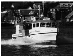
Narfi SU 680. Skipaskr.nr. 2485. Smíðaður: Hafnarfirði 2001, plast. Stærð: 7,09 brl. 5,92 bt. Mesta lengd: 9,49 m. Skráð lengd: 8,02 m. Breidd: 2,97 m. Dýpt: 1,22 m. Vél: Yanmar 276 kW. Fjöldi skipverja: 2
