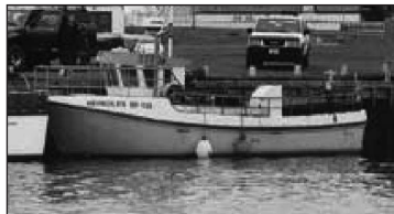
Herkúles SF 125. Skipaskr.nr. 1770. Smíðaður: Akureyri, 1986, plast. Stærð: 7,51 brl. 7,33 bt. Mesta lengd: 8,87 m. Skráð lengd: 8,78 m. Breidd: 3,07 m. Dýpt: 1,58 m. Vél: Sabre 88 kW Fjöldi skipverja: 3
