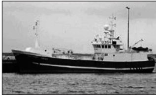
Valdimar GK 195. Skipaskr.nr. 2354. Smíðaður: Stál, Noregi, 1982. Stærð: 344 brl. 569 bt. Mesta lengd: 41,63 m. Skráð lengd: 38,00 m. Breidd: 8,50 m. Dýpt: 6,55 m. Vél: Callesen 508 kW (690 hö). Fjöldi skipverja: 14
