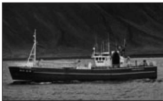
Grundfirðingur SH-24. Skipaskr.nr. 1202. Smíðaður: Stál, Garðabæ, 1972. Stærð: 151 brl. 255 bt. Mesta lengd: 35,37 m. Skráð lengd: 32,20 m. Breidd: 6,70 m. Dýpt: 5,55 m. Vél: Caterpillar 578 kW Fjöldi skipverja: 9
