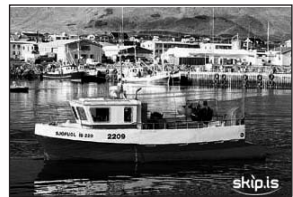
Sjófugl ÍS 220 Skipaskr.nr.: 2209 Smíðaður: Gdansk Póllandi 1990 Plast Stærð: 5,00 brl; 7,00 bt Lengd: 9,97 m Breidd: 2,87 m Dýpt: 1,11 m Vél: Deutz Vetus 121,00 kW
