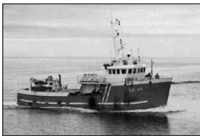
Guðfinnur KE-19. Skipaskr.nr. 1371. Smiðaður: Stál, Seyðisfirði, 1974. Stærð: 78 brl. 75 bt. Mesta lengd: 24,68 m. Skráð lengd: 23,14 m. Breidd: 5,20 m. Dýpt: 2,10 m. Vél: Scania 359 kW. Fjöldi skipverja: 7
