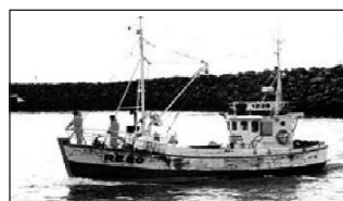
Dögg ÍS-54 Skipaskr.nr. 1228 Smíðaður: Eik, Skagaströnd, 1972. Stærð: 21 brl. 20 bt. Mesta lengd: 15,20 m Skráð lengd: 13,68 m Breidd: 3,89 m. Dýpt: 2,02 m Vél: Cummins 221 kW Fjöldi skipverja: 2
