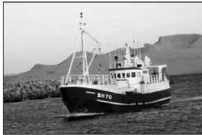
Rifsari SH 70 Skipaskr.nr. 1856 Smíðaður: Gdansk, Póllandi 1987, stál. Stærð: 81 brl., 98 bt. Mesta lengd: 25 m. Skráð lengd: 22 m. Breidd: 6,00 m, Dýpt: 3,00 m. Vél: Caterpillar 459 kW Fjöldi skipverja: 5
