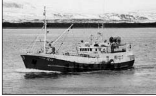
Sigurvon BA 55. Skipaskr.nr. 1343. Smíðaður: Akureyri, 1974, stál. Stærð: 142 brl. 224 bt. Mesta lengd: 31,22 m Skráð lengd: 28,20 m Breidd: 6,70 m Dýpt: 5,60 m Vél: MWM 563 kW. Fjöldi skipverja: 6
