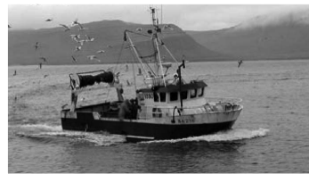
Brekey BA 236. Skipaskr.nr. 1890. Smíðaður: Stál, Ísafirði, 1988/4. Stærð: brl. 11. bt. 22. Mesta lengd: 14,00 m. Skráð lengd: 13,00 m. Breidd: 3,00 m. Dýpt: 1,00 m. Vél: Caterpillar 147 kW
