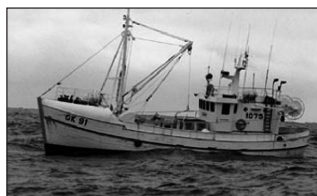
Austurborg SH 56. Skipaskr.nr. 1075. Smíðaður: Stykkishólmi, 1969. Stærð: 47 brl. 49 bt. Mesta lengd: 20,00 m. Skráð lengd: 18,00 m. Breidd: 5,00 m. Dýpt: 2,00 m. Vél: Caterpillar 247 kW
